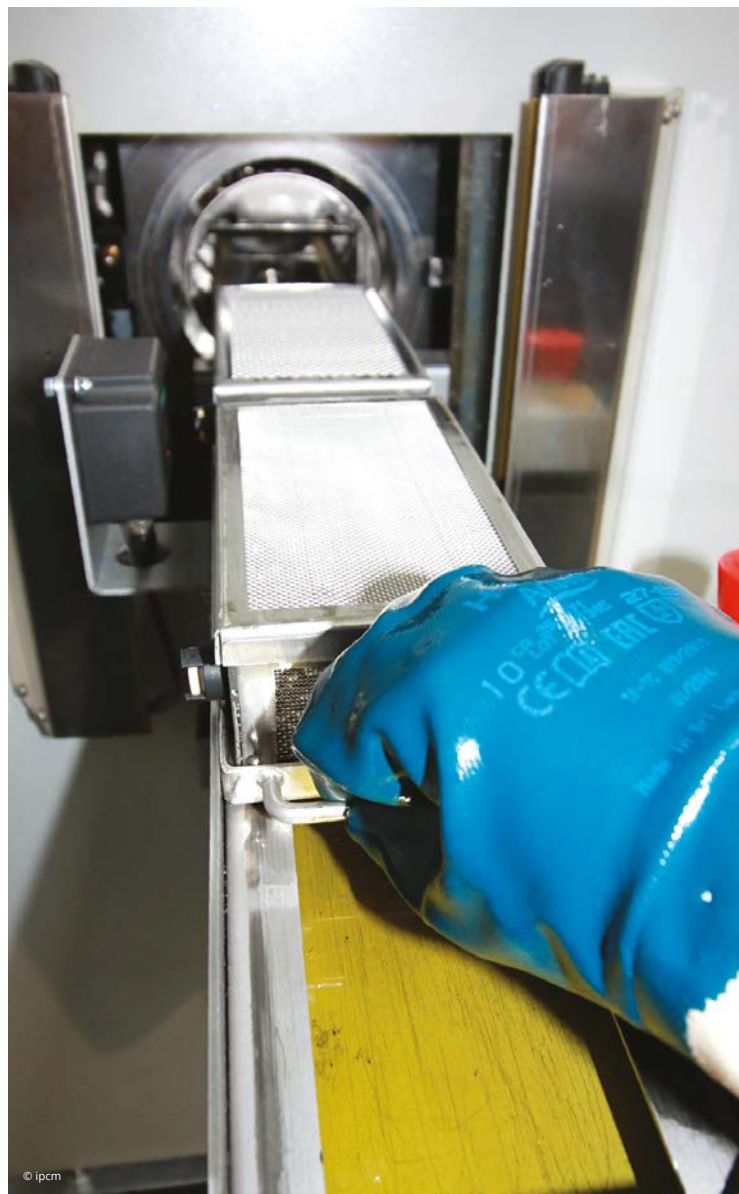
Two baskets are loaded in the cleaning chamber at a time. Nella camera di lavaggio sono inseriti due cesti alla volta.
