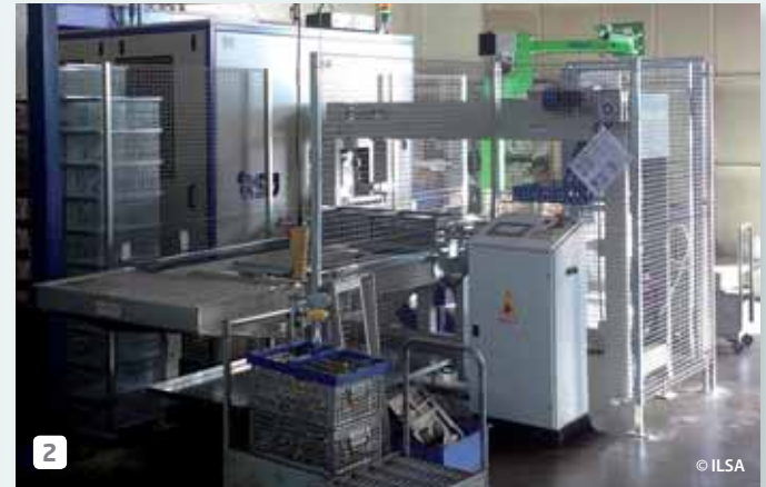
2 The mod. IK40 machine with automatic double drum loading. Macchina mod. IK40 con caricamento automatico a doppio cestello.
